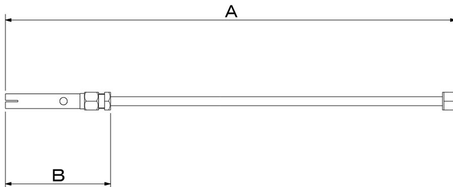
※接続・・・袋ナット(内径:1/8")型、オスネジ(外径:M8)型があります。
